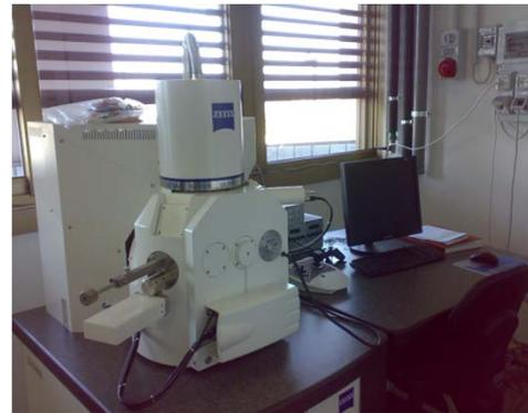
Analisi morfologica dettagliata (risoluzione  $\approx 2 \text{ nm}$ ), ad altissimi ingrandimenti, dei vari componenti di una fibra ottica e di osservare la presenza di eventuali imperfezioni:
