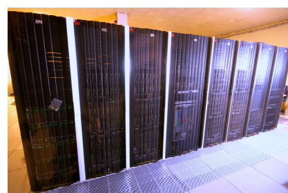
Il cluster lagrange, la cui espansione è dedicata ai progetti selezionati per LISA Sistema operativo: Linux RedHat Enterprise 5.5 Peak performance: 45 TFlops/s Measured performance: 35 TFlops/s Connettività: Infiniband QDR (40Gb/s 1µs latency) per il message passing, Gigabit ethernet per il file sharing Unità di calcolo: 4032 RAM: 24 Gb/node Dischi: 26 TB shared
