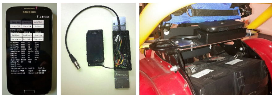
Fig. 2 – Lo smartphone Galaxy S4 su cui gira l'app di controllo (sinistra), e una foto dei dispositivi contenuti nell'involucro inferiore (centro). Setup finale nella parte posteriore della CE (destra), posizionato grazie alla piastra di metallo.
