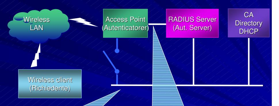
La porta Controlled impedisce l'accesso ai client della LAN La porta Uncontrolled permette all'authenticator di contattare il server di autenticazione
