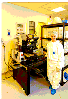
Unità foto e nano-litografica per la realizzazione di strutture ordinarie su scala nanometrica. Tale strumentazione opera in una camera pulita di 110 m 3 , un ambiente a temperatura, umidità e contaminazione da polveri altamente controllate per limitare l'influenza di agenti esterni sui processi di nano-lavorazione, che risulterebbero compromessi da operazioni in ambienti con anche un minimo contenuto di polvere o altre particelle.
